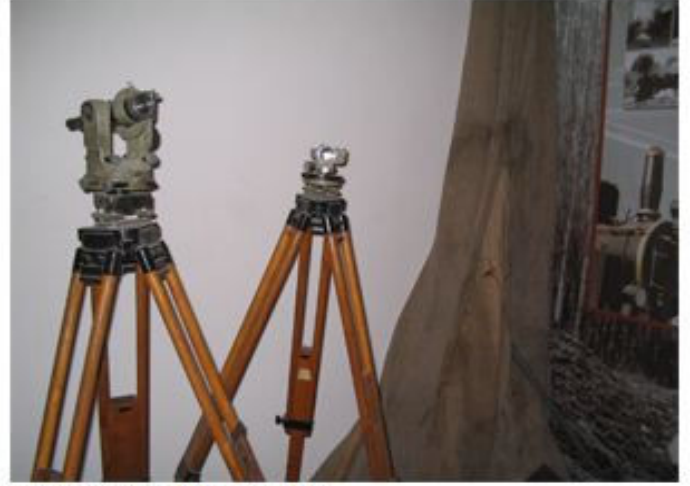
Yol ölçüm aleti (teodolit-20.yy)
