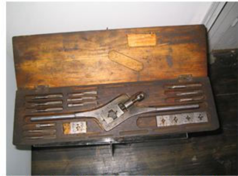
Boru ve demir çubuklara diş açma makinesi (pafta-19.yy)
