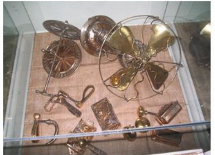
Yolcu vagonu içi gereçleri (havalandırma diskisi, vantilatör, kapı kolları, küllükler vb-19.yy)
